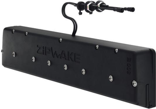
所有组件都经过精心设计，能够承受冲击并避免进水，从而最大限度地降低了昂贵的维护和停机风险。拦截器或叶片的驱动是通过拦截器单元中的免校准潜水电动单或双伺服系统进行的。自然水冷为在12-32伏电压下运行的无刷直流伺服电机提供了良好的工作条件。
