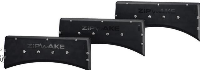
R500、R600和R800这三种不同半径的隧道模型确保了大多数大型船只螺旋桨隧道可以覆盖，船体和拦截器曲率之间的偏差可以忽略不计。隧道拦截器可以包含在新的安装中，也可以改装到已经安装的系统中。
