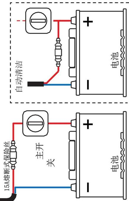
注意！如果使用拦截器自动清洁，则直接将电源连接到蓄电池正极接线柱。
